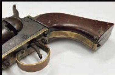
和製コルト1851ネイビー／ 5連発、口径9mm、全長285mm
