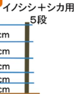
イノシシやシカは、下をくぐろうとするので、最下段の高さが特に重要です。最下段はイノシシの鼻の高さである地上20cmに来るようにします。これ以上隙間が空くと、イノシシが柵線に気づかず通り抜けることがあります。設置時に支柱に目印を書いておくと、管理時に便利です。
